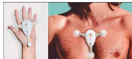
Figura 9. Gravador Quoreone (da Quoretech®), sem fios e com baterias com duração de até 7 dias contínuos, que funciona tanto para gravações de longa duração (até 30 dias com recarga semanal de bateria) como também sistema looper para correlação de sintomas pouco frequentes e eventuais distúrbios do ritmo cardíaco.
